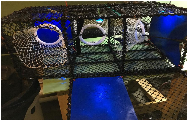
Fig. 11 Modifisert krepseteine (åpen) til bruk i forsøk
